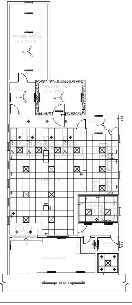
PROJECT:-**ELECTRICAL DETAIL** EXHAUST FAN **BRACKET LIGHT** DISTRIBUTION BOARD WALL MOUNTED FAN SPOT LIGHT DOWN  $\Phi$ LIGHTER CEILING FAN **TUBE LIGHT** COMPUTER CABLE CONNECTION
