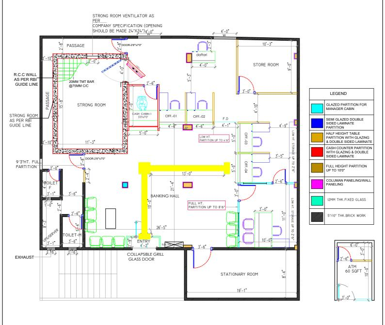
NAUGACHIA BRANCG- BRANCH AT FIRST FLOOR BEAM BOTTOM HEIGHT-8'9" CILLING HEIGHT-9'3"
